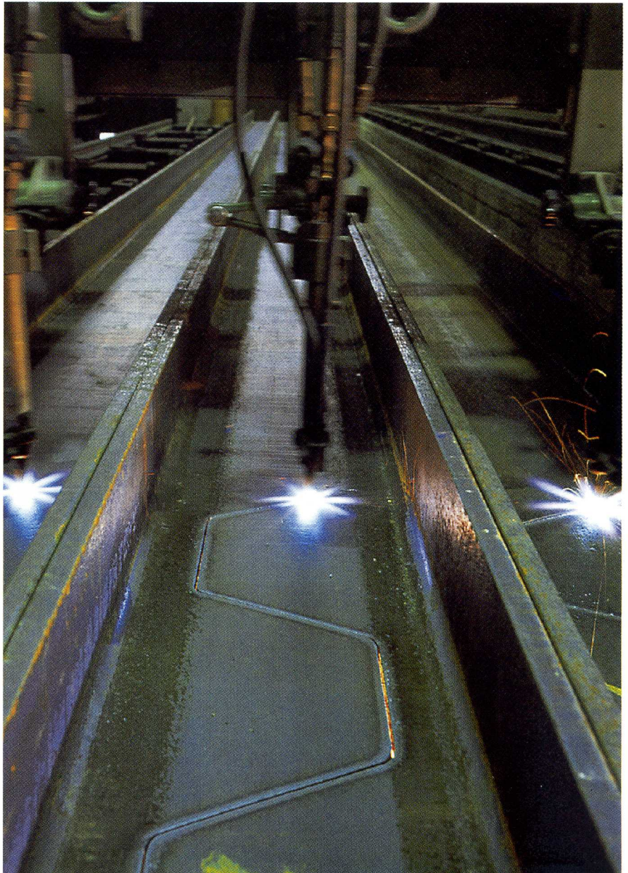
Auftrennen eines Wabenträgers
