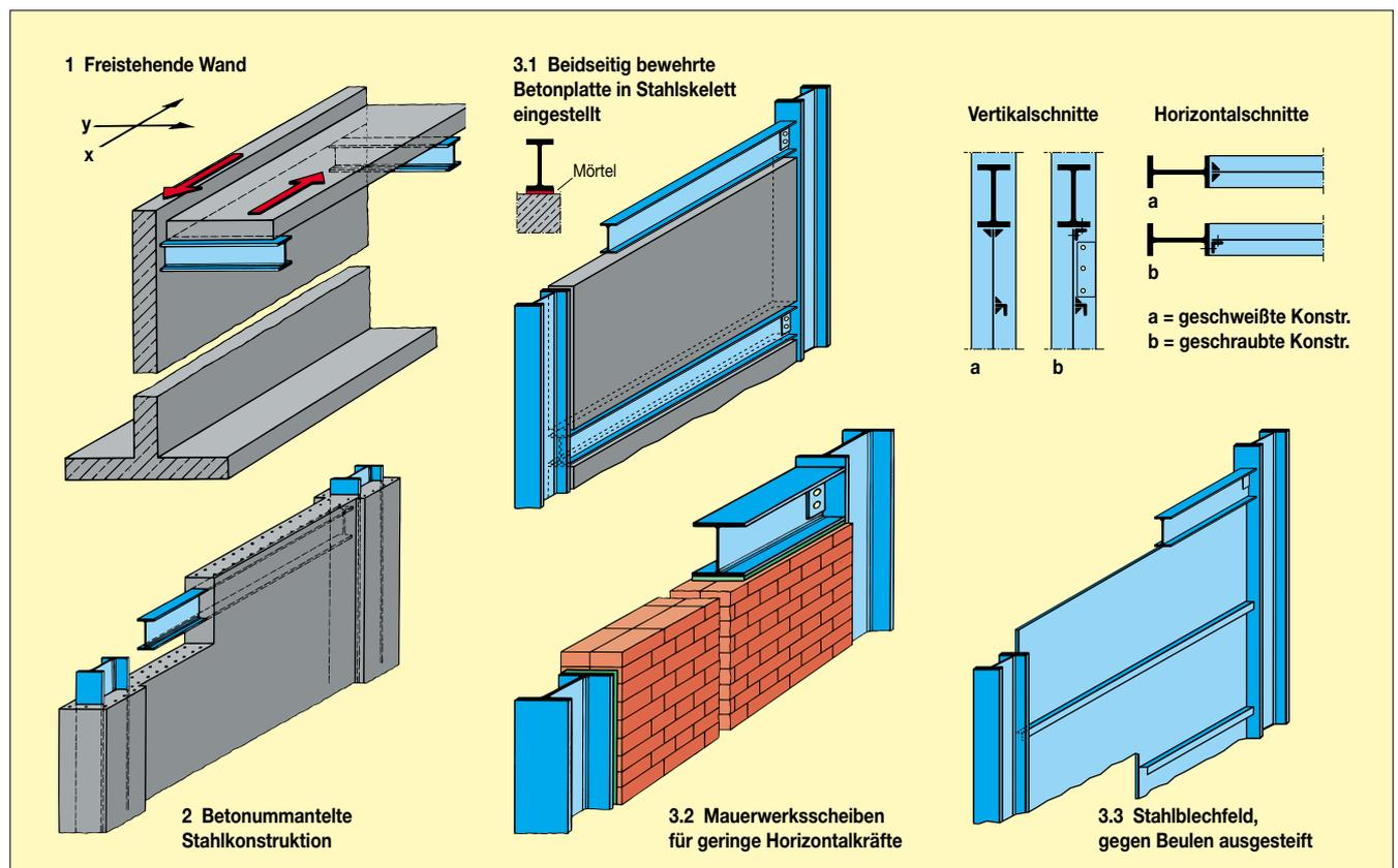
„Vollwandträgern“ geschlossen. Die Bleche werden allseitig kraftschlüssig mit den Profilen durch Schweißen oder Schrauben verbunden. Die Blechfelder werden nach den statischen Erfordernissen gegen Beulen ausgesteift. Diese Bauweise ist zum Abtragen sehr großer Horizontalkräfte geeignet.
