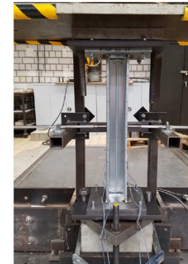
Versuchsaufbau für Stützendruckversuche - DIN EN 1993-1-3, A.3
