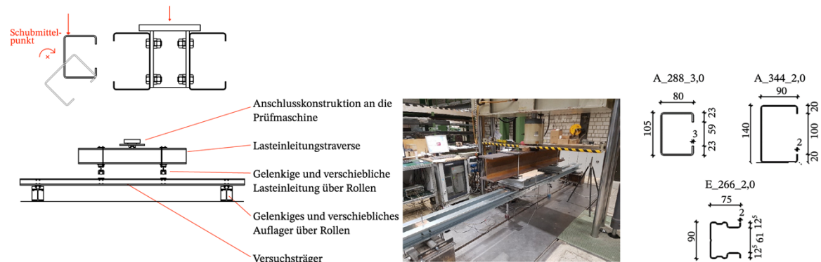
Vierpunktbiegeversuche nach DIN EN 1993-1-3, A.3.3 für Versuchskörper mit hoher Beanspruchbarkeit
