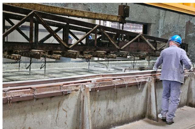
Untrennbar: Im 450° C heißen Schmelzbad verbindet sich das flüssige Zink mit dem zu schützenden Stahl.
