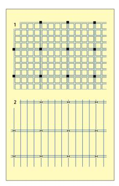
2 Die gleiche Stützenanordnung ist bei einem Stahlskelettbau möglich. Dabei werden die quadratischen Deckenfelder in langgestreckte Deckenelemente bestehend aus quergespannter Deckenplatte auf Deckenträgern aufgelöst. Die Deckenträger (Träger erster Ordnung) geben ihre Lasten an Unterzüge (Träger zweiter Ordnung) ab. Deckenträger und Unterzüge haben gleiche Spannweiten. Diese Konstruktion stellt im Stahlbau jedoch nicht die optimale Lösung dar.
