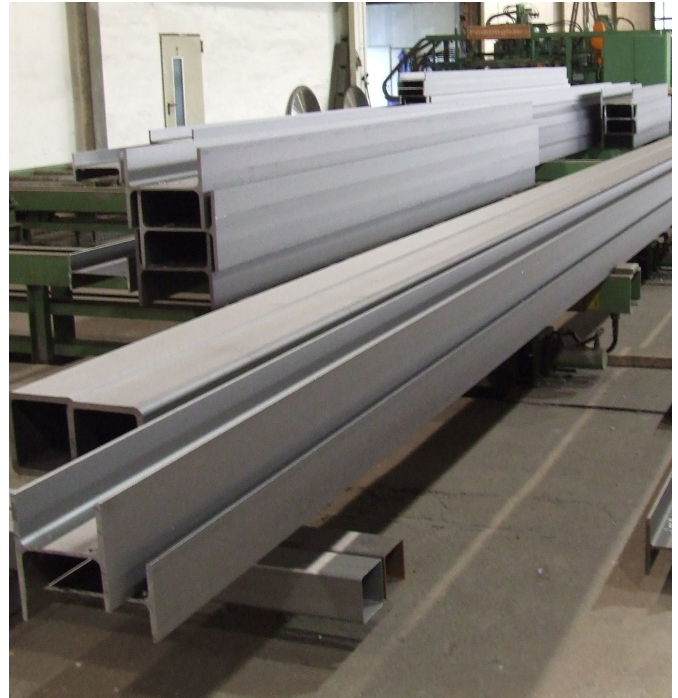
Bild 4: Standardprofile für Typenhallen © RSB Rudolstädter Systembau
