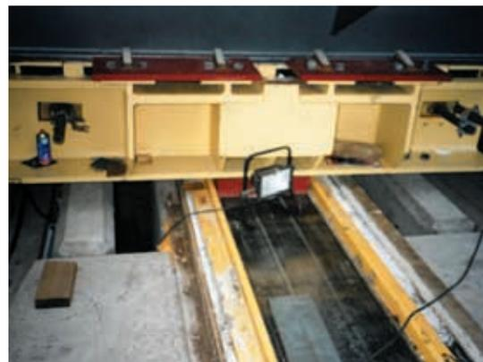
Abb. 8: Verschlager mit Querverschubbahn
