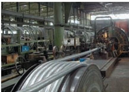
Abb. 4: Herstellung der Brückenseile mittels einer besonderen Verseilmaschine
