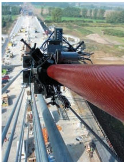
Abb. 5: Seilprüfung mit Magnetsensor
