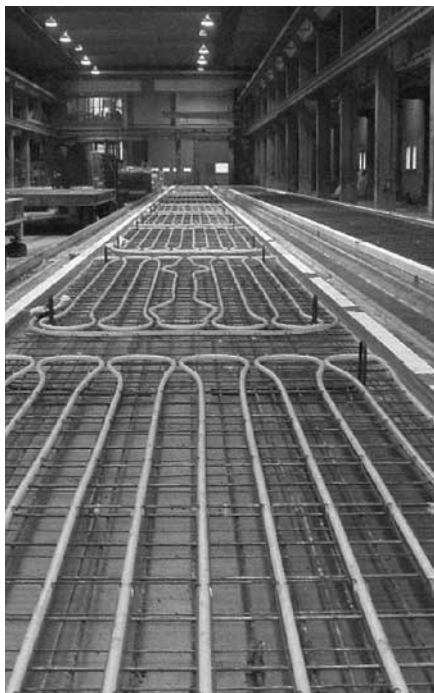
Bild 4a - c: Thermisch aktive Betonfertigteile für Stahltragwerke
