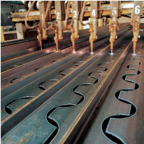
Bild 24: Herstellung im Werk
