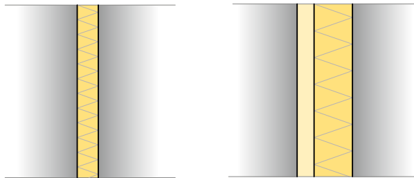
Abb. 3.3.5: Beispiele für zwei schwere biegesteife Schalen
