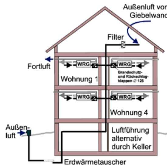
Abb. 4.6.4: dezentrale Wärmerückgewinnung je Wohnung, Quelle Fa. Paul
