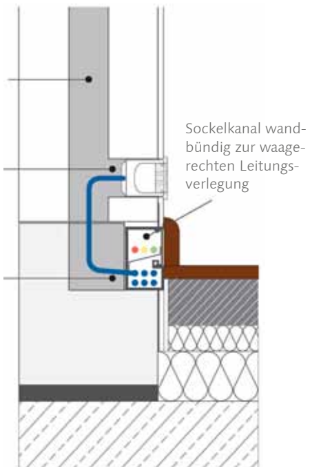
Abb. 26/27: vertikale und horizontale Kabelverteilung durch den Quadro Etronic
