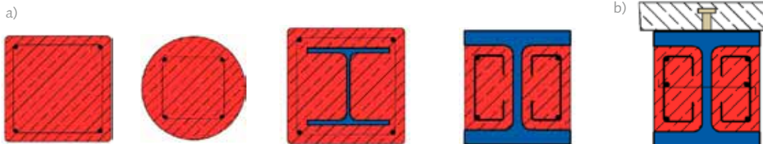
Abb. 5.6: Klassifizierte Verbundstützen (a) und -träger (b)
