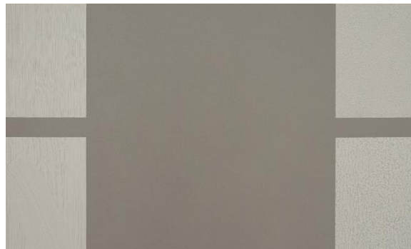
Bild 2: RAL 9007, Graualuminium Einfluss Streichen / Rollen auf den Farbton
