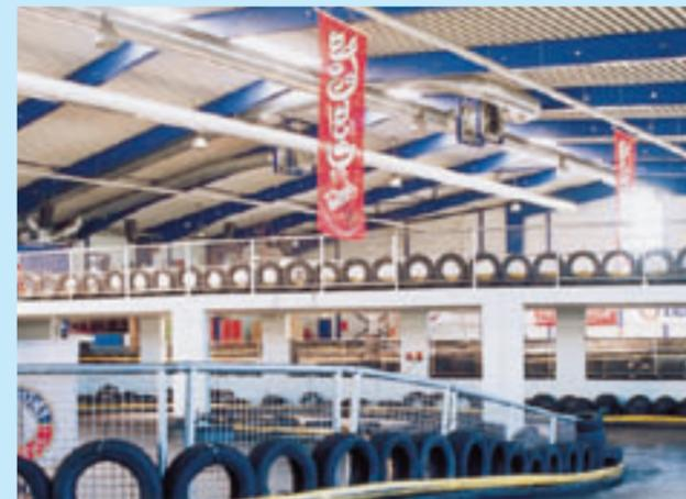
Eine Stahlhalle mit einer trapezförmigen Grundfläche von rund 48 x 60 Metern überdacht eine 400 Meter lange und 6 bis 8 Meter breite Rennbahn.
