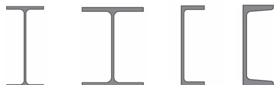
Bild 30: Übersicht gängiger warmgewalzter Unterkonstruktionsprofile
