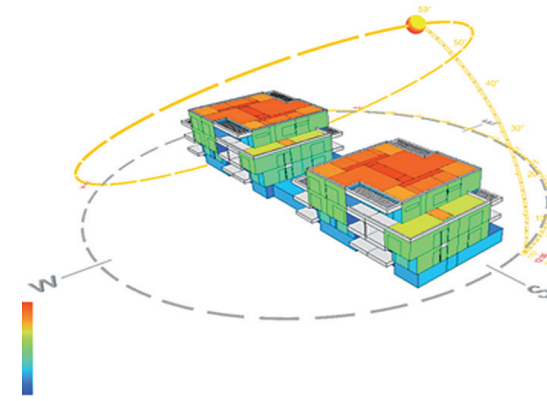
Energiesimulation, BIM Modell, Adaptive Stahlhäuser Lüneburg, RMA Architekten Essen
